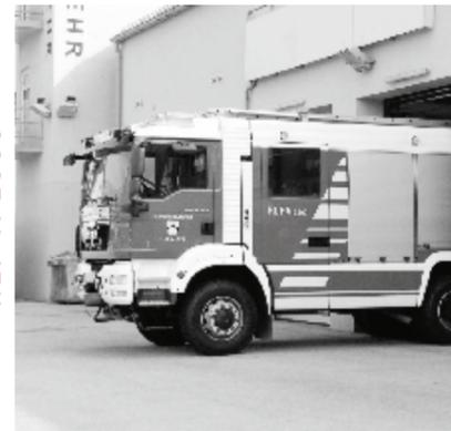
Das erstausrückende Fahrzeug ist, auf Grund seiner Vielzahl an Einsatzmöglichkeiten, das Rüstlöschfahrzeug. Mit seinem eingebauten 2000 Liter Wassertank und der umfangreichen Beladung an technischen Geräten – zum Beispiel Bergeschere, hydraulischer Spreizer, Seilwinde und Hochdruckstrahlrohr – kann ein qualifizierter Erstangriff durchgeführt werden. Durch die Flexibilität der Geräte im Fahrzeug können im Einsatz erste Maßnahmen getroffen werden, noch bevor nachfolgende Fahrzeuge eintreffen.
